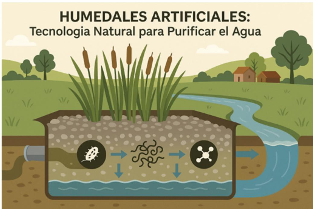
Representación esquemática de un humedal artificial para tratamiento de aguas residuales
